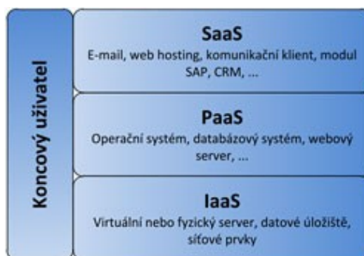
Obr. č. 5: Architektura služeb zařazených v cloudu podle jednotlivých modelů [12].
